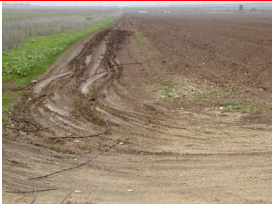
חרסית שמנה, חומה - יחידה גיאוהנדסית I. מבט למערב מאזור צומת יגור.
