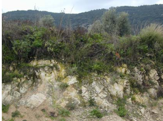
קרטון מסיבי, סדוק - קומפלקס קרטוני, גיל סנון (יחידה גיאוהנדסית IV). מעלה המדרון באזור חתך 608.
