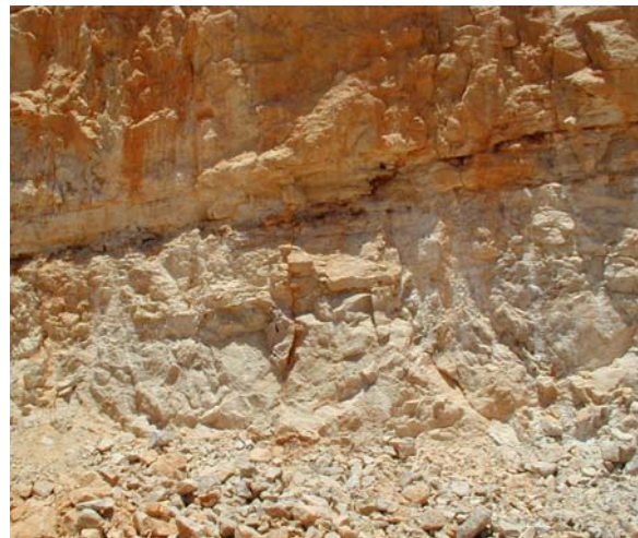
מעברים בין דולומיט, אפור, קשה בעל חוזק גבוה לשכבות דולומיט גירי, מקומית קרטוני חולי. פינה צפון מזרחית של מפלט 1.
