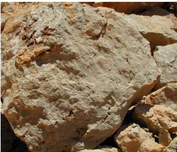
"אבן שאריתית" (דולומיט) שהתקבלה בעקבות פיצוץ. בפני האבן סידוק, מעט פתוח, וחללי המסה קטנים.
