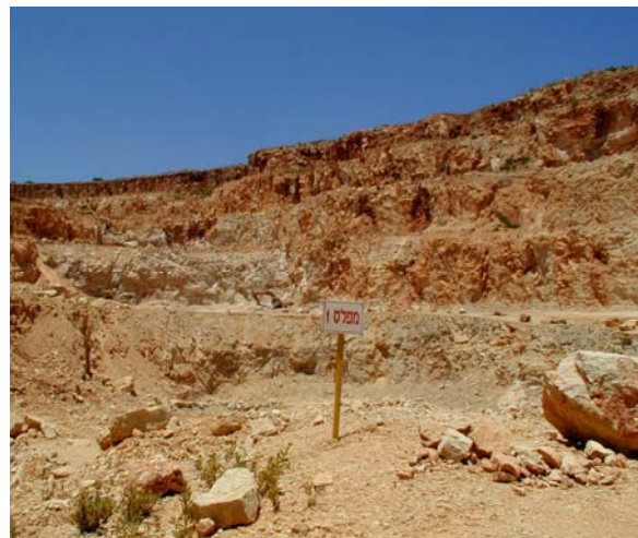
5 קירות/מדרגות החציבה מהן בוצעה עד כה הכרייה. בפני הקירות ריבוי בסימני המסה. בחזית מספר גושי דולומיט שנתקבלו לאחר פיצוץ להפקת סלע לגריסה.
