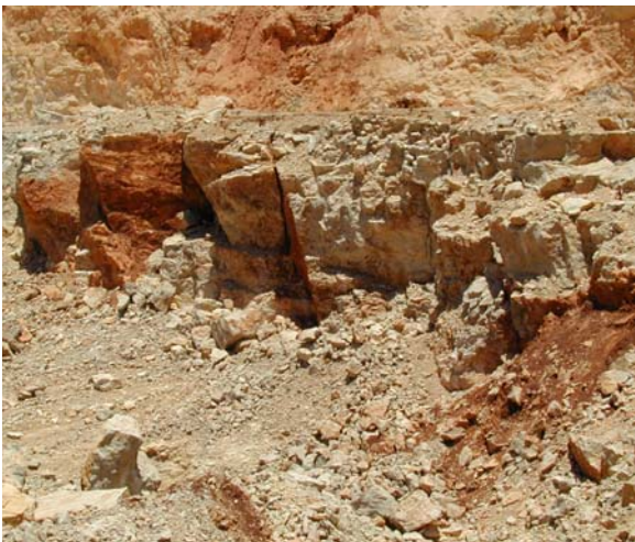
דולומיט, אפור, קשה, משוכב עבה (עובי כ-1 מטר), סדוק אנכית עד תת-אנכית. במישורי הסידוק מריחות חרסית. שכבה ממנה ניתן להפיק אבן מגודל D.
